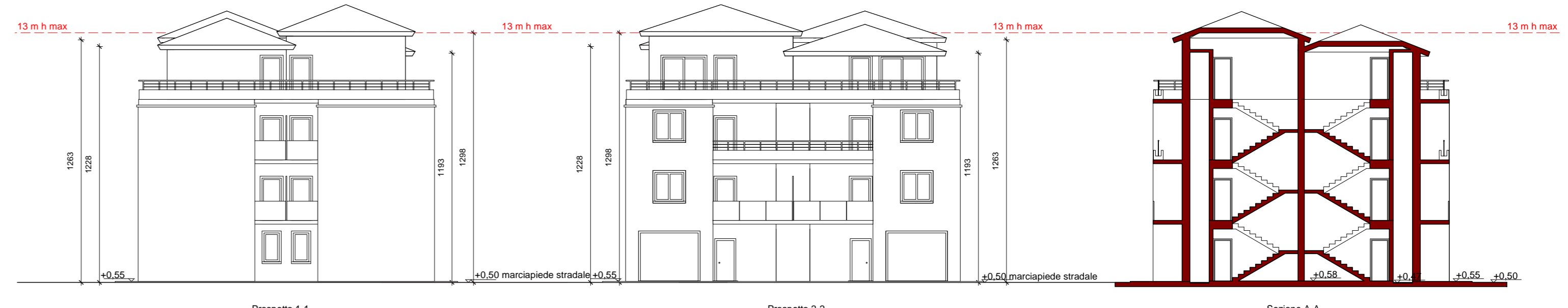
Tipologia quadrifamiliare: prospetti e sezione
